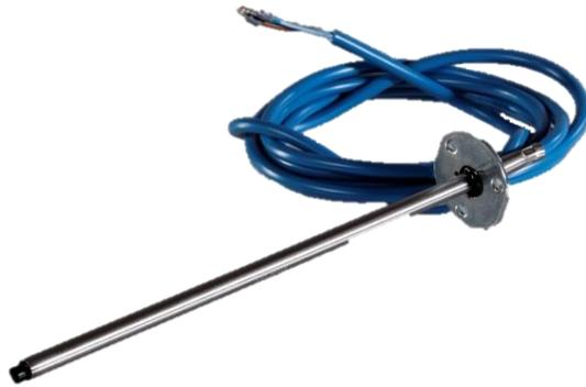
Schnellansprechender Lufttemperaturfühler KTY 81-210 mit 2,0 m PVC-Kabel für die Montage im Luftkanal
